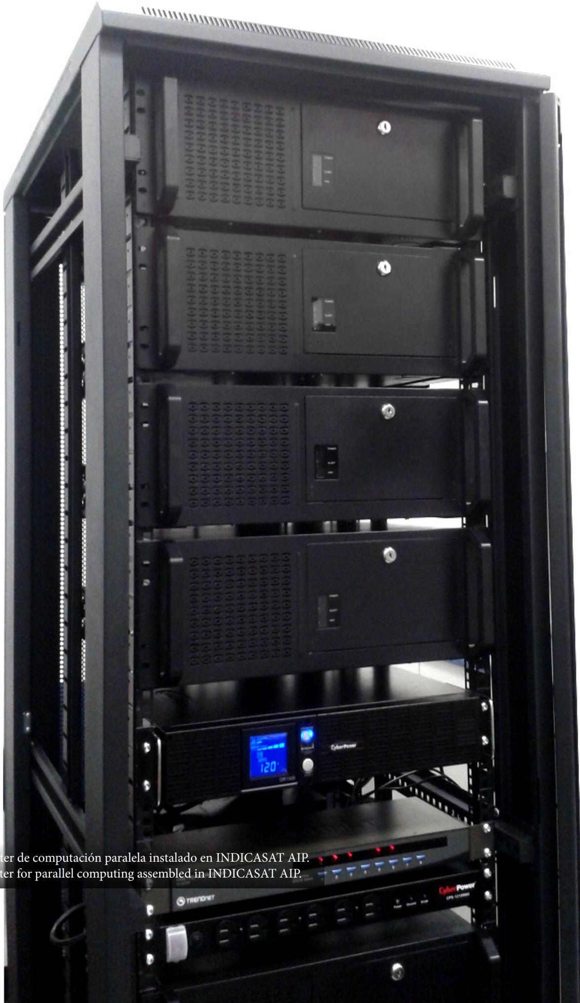
Figura 3. Cluster de computación paralela instalado en INDICASAT AIP.
